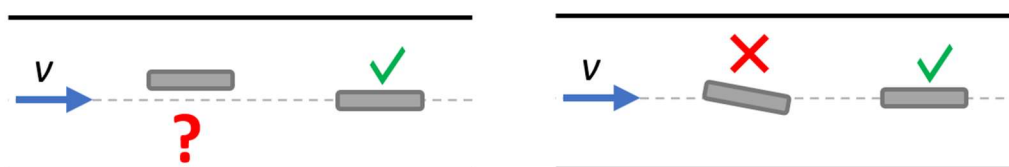
Figur 3-2 Plassering av sensorer i måletverrsnittet, NVE etter Nivus GmbH (2020)
