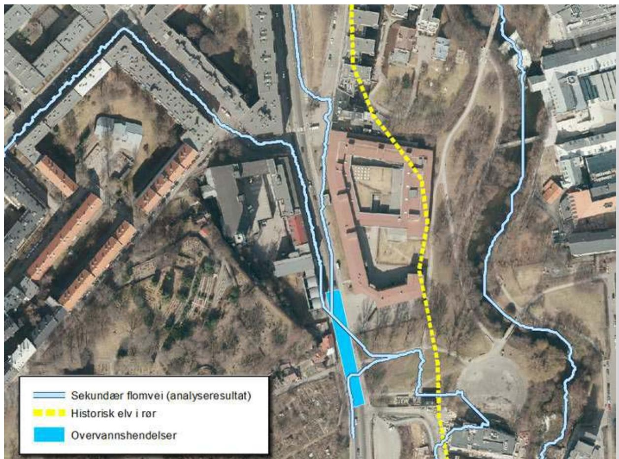
Figur 5. Aktsemdkart for sekundære flaumvegar i Oslo testa mot historiske og kjende flaumhendingar/overfløymingar. Illustrasjonen viser at det er godt samsvar mellom analyseresultata og historiske bekkeløp og hendingar. Frå: «Klimatilpasning i Norge. Aktsomhetskart for overvann – sekundære flomveier».
