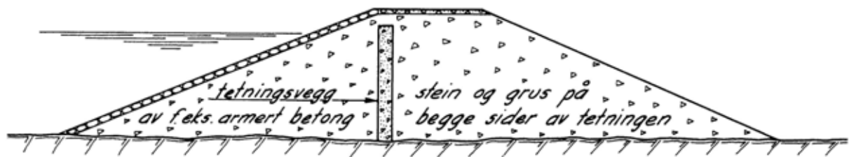
Fig. 3.4 Fyllingsdam med tetningsvegg inne i dammen.
