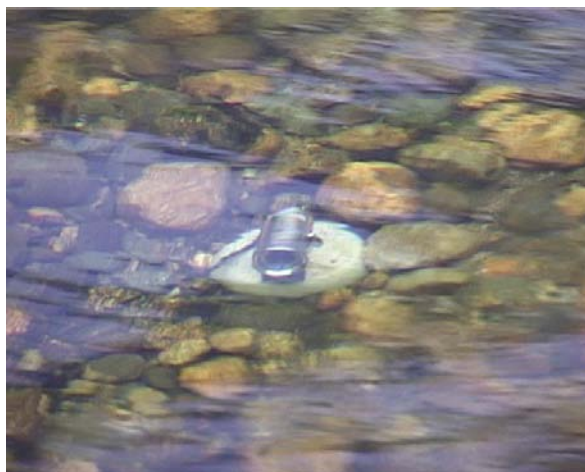
Figur 2. Videokameraene var plassert på en tung plattform på bunnen.
