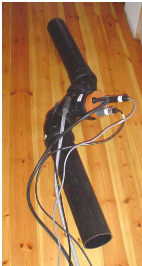
Figur 4. Rør med sensorer for oksygen, pH, vanntemperatur, vannstand og turbiditet.
