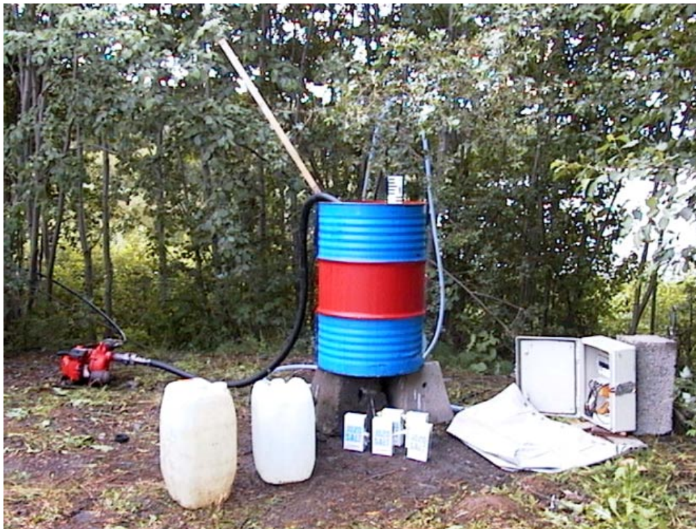
Bilde 3. Undersøkelser med kunstig sporstoff. Injeksjon av radioaktive sporstoff i rør 4 (a) og rør 5 (b); Injeksjon av 200 l vann med rhodamin og koksalt i rør 7 (c). På de øverste bildene: Carsten Qvenild (Institutt for energiteknikk, IFE)
