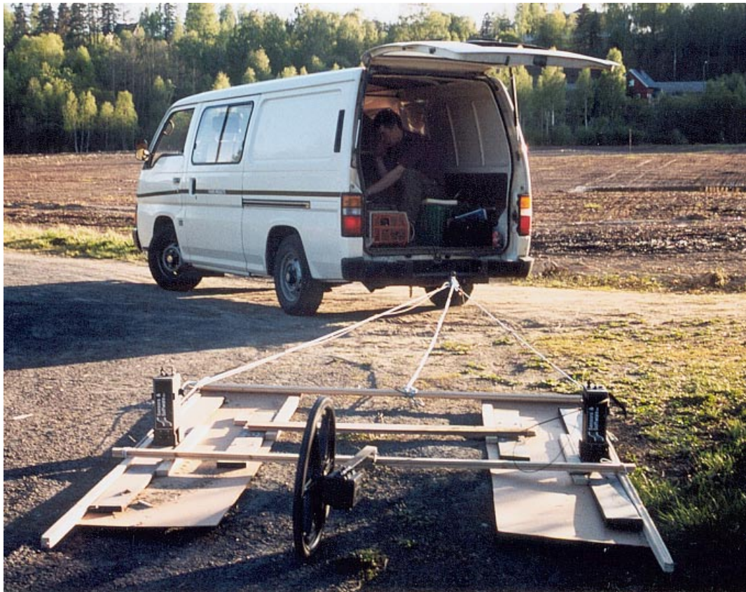
Bilde 1. Georadarundersøkelser. Ved Rena ble georadar montert på båt (a), fraktet på en slede og ski (b) eller tauet etter bil (c). På bildene Tor Simon Pedersen og Monica Sund (begge NVE, Hydrologisk avdeling).
