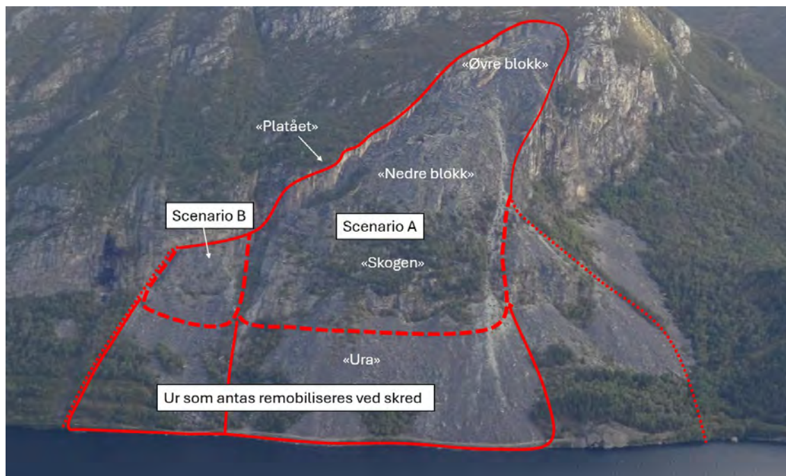
Figur 2: Skråfoto av Skutshorn. Det ustabile området er avgrenset med rødt. Skredscenario A og B samt uformelle navn på delområdene er angitt. Modifisert etter NGU, 2024.
