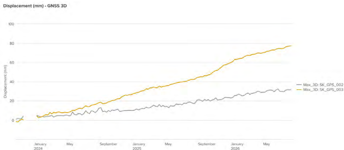
Figur 10: Målte bevegelser for GNSS siden måleserien startet i desember 2023. Årlig bevegelse varierer fra om lag 1 til 3 cm per år for de to instrumentene.
