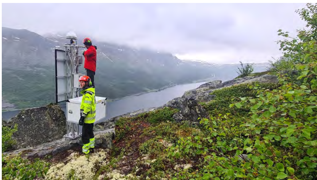
Figur 8: Montering av ett av GNSS-systemene (SK-GPS-2) på «øvre blokk» på Skutshorn. Foto: Gustav Pless / NVE
