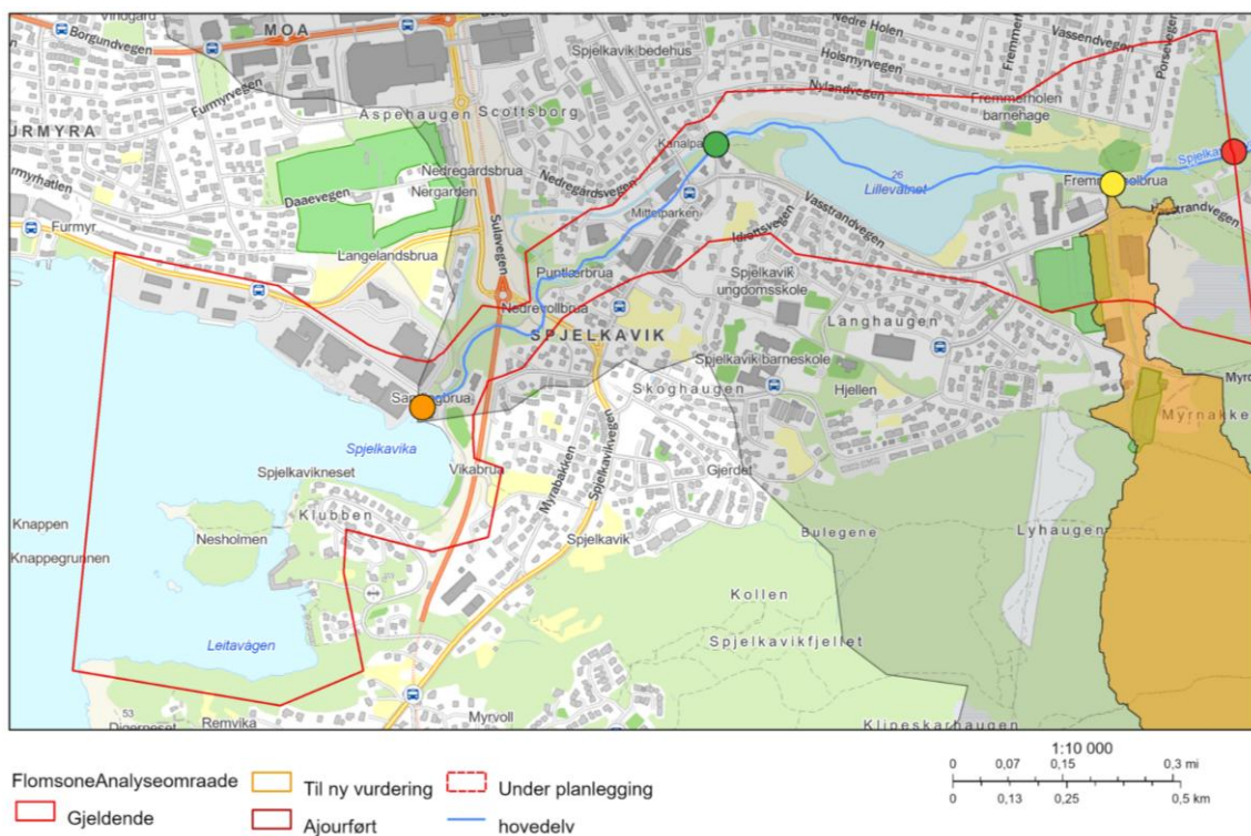
Figur-1: Kartet viser flomberegningene i Spjelkavikvassdraget (rød = Spjelkavikelva nedstrøms Brusdalsvatnet, gul = sidebekken, grønn = Spjelkavikelva nedstrøms Lillevatnet, og oransje = Spjelkavikelva ved utløp i fjorden). Gjeldende flomsonekart for Spjelkavikelva er også vist i kartet. Kartet er laget i NVE Temakart .
