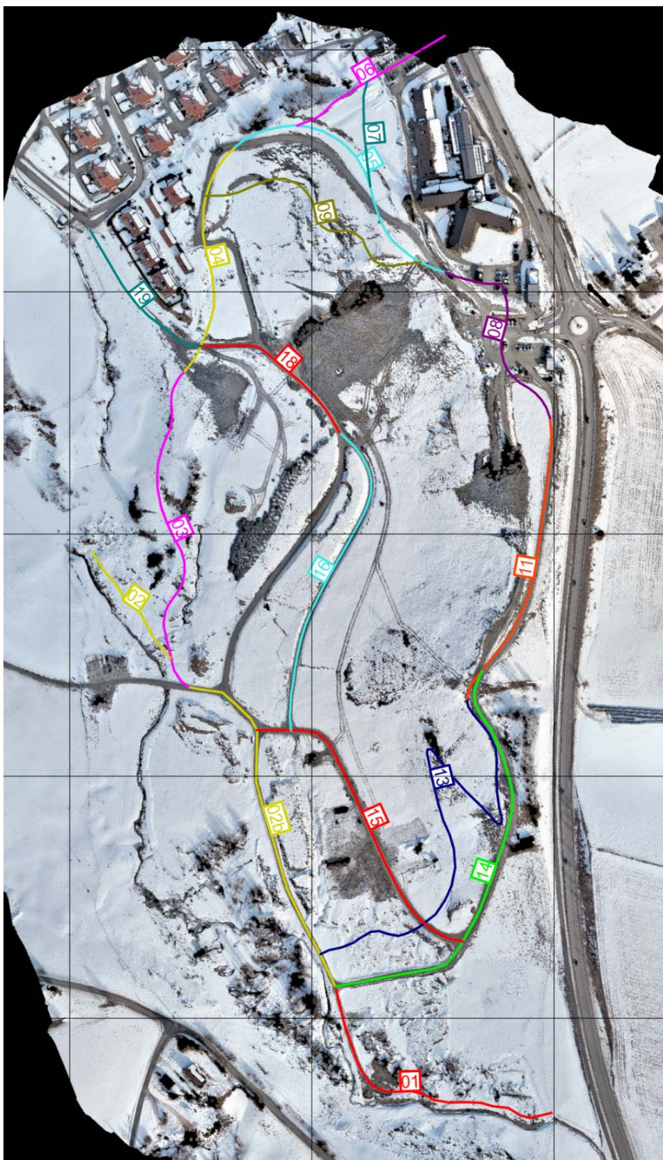
Figur 10. Oversikt over størstedelen av de interne anleggs-/adkomstveiene som ble etablert i skredgropa.
