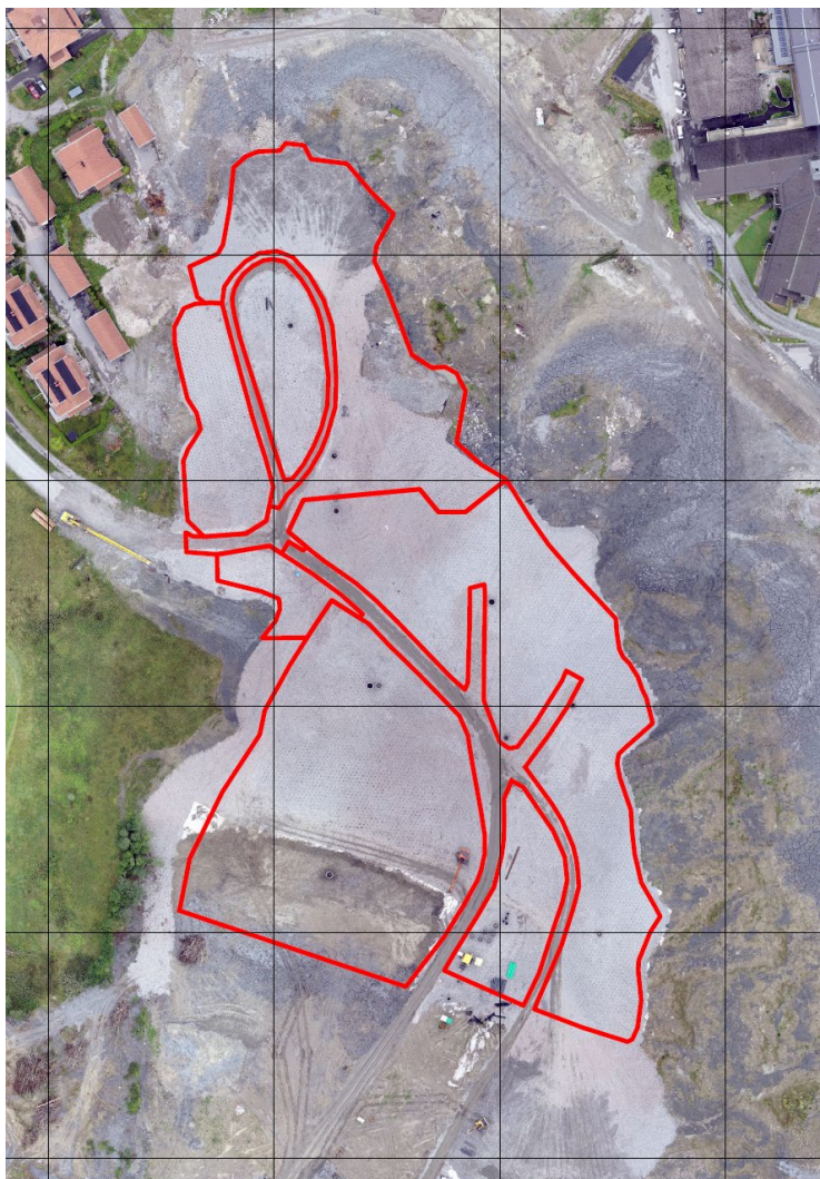
Figur 19. Områder med installerte vertikaldren. Størrelsen på rutenettet er 75 m. Nederst til venstre er drenslaget/arbeidsplattformen dekket med oppfyllingsmasser, som etter hvert blir foten av motfyllingen videre oppover i skredgropa.
