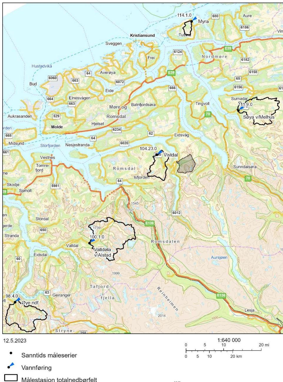
**Figur 4: Plassering til nærliggande samanlikningsstasjonar for Dokkelva. Svart omriss: Nedbørfeltsgrenser til samanlikningsstasjonane. Blå pil: Plassering til målestasjon. Feltet til Dokkelva er markert i grått. Kartet er laga i NVE Temakart.**
