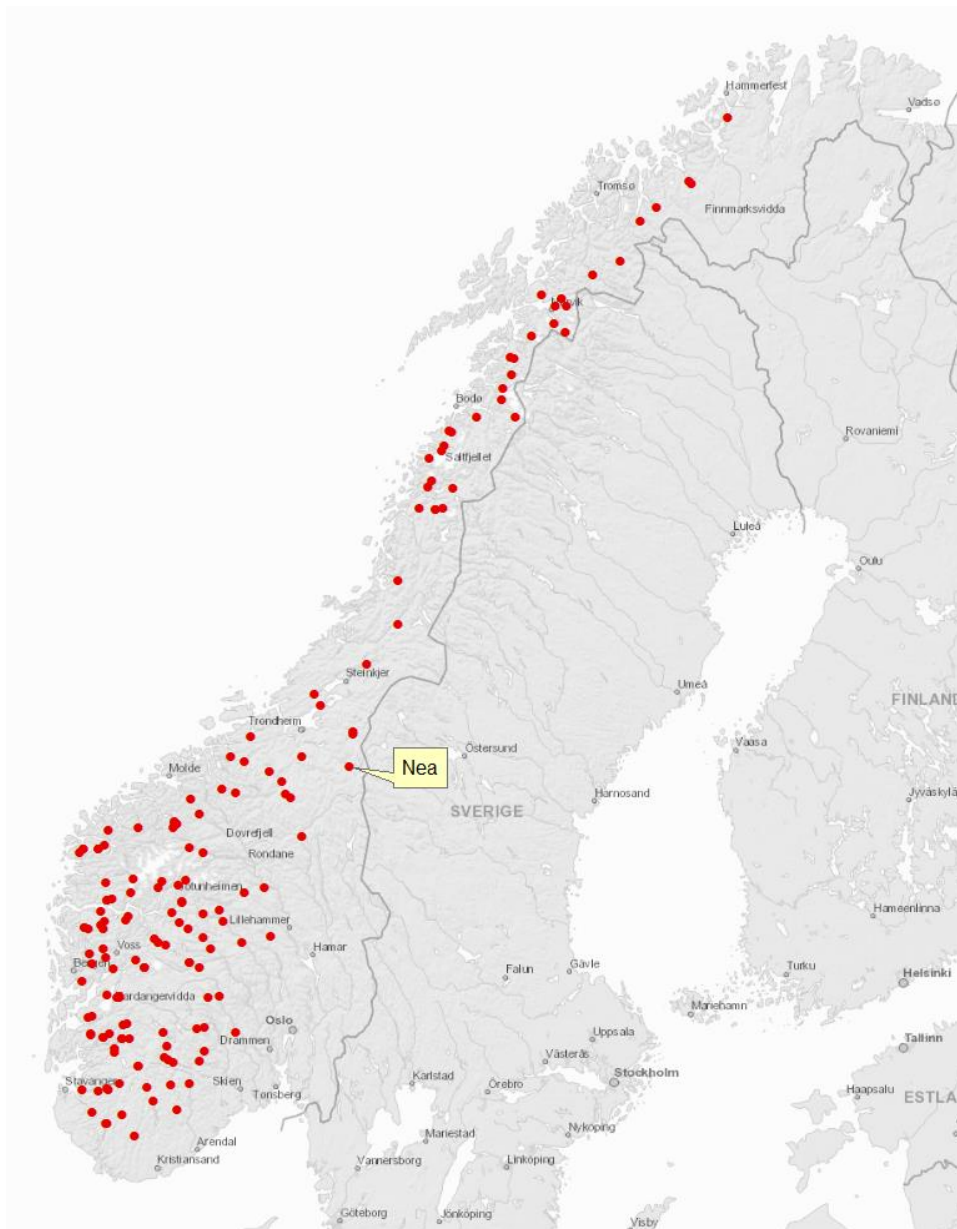
Figur 4 Lokalisering av høytrykksanlegg i Norge, med fallhøyde over 200 m og ytelse over 10 MW. Kart: NVE.
