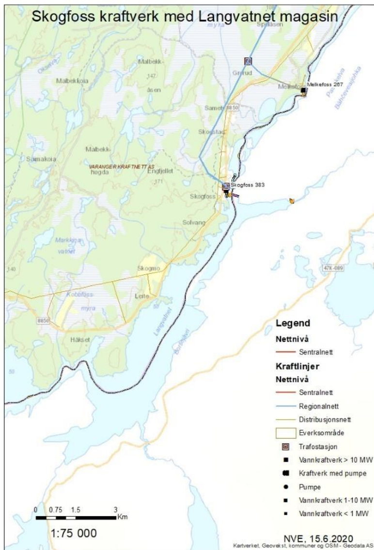
Figur 15 Skogfoss og Melkefoss kraftverk i Pasvikelva. Langvatnet fungerer som inntaksmagasin for Skogfoss. De blå streker er kraftlinjer.
