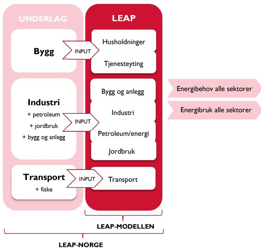
Figur 1-1 Skjematisk oversikt over LEAP-Norge. NVEs LEAP-modell gir ut energibehov og energibruk. Inn i modellen går input fra tre underlagsmodeller i Excel. LEAP-modellen og underlagsmodellen omtales sammen som «LEAP-NORGE»
