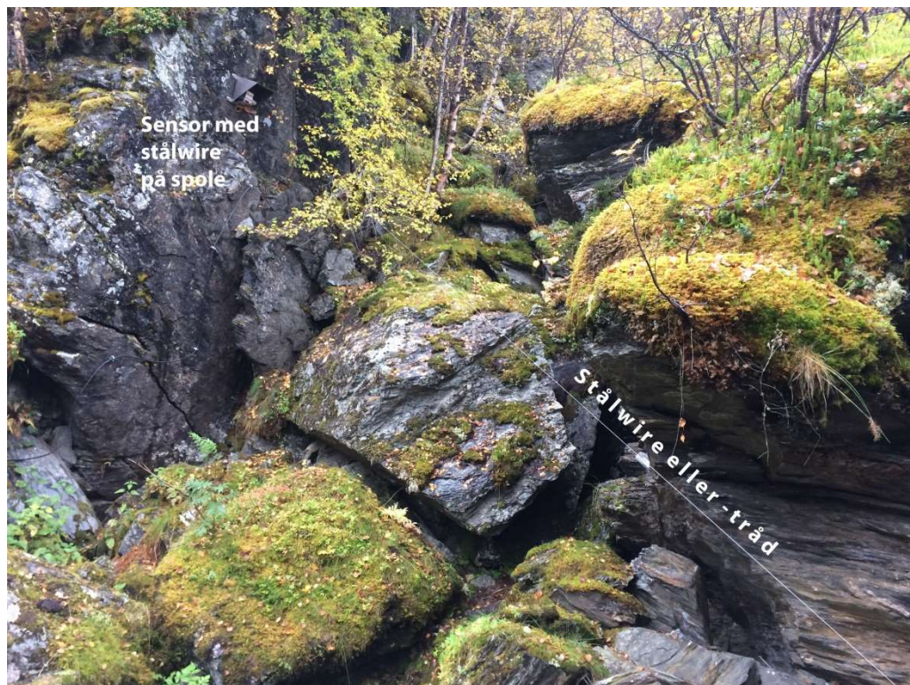
Figur 9 Wire-ekstensometer på Joasetbergi som måler over en 10 m bred bakksprekk.
