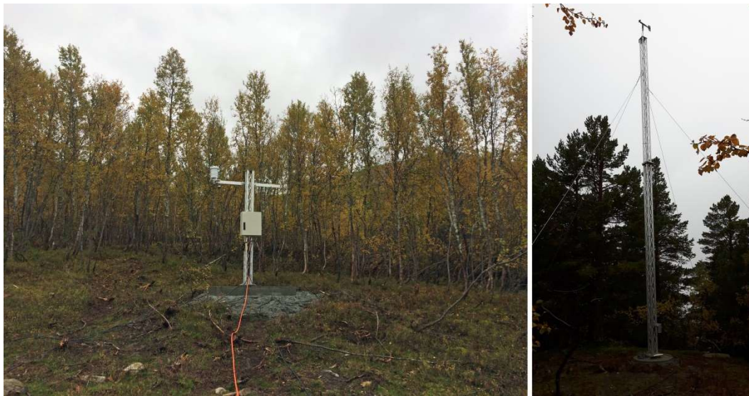
Figur 11 Værstasjon. Venstre: Temperatur (luft-fjell), fuktighet- og snødybdemåler. Høyre: Vindretning og styrke i 10 m høyde.
