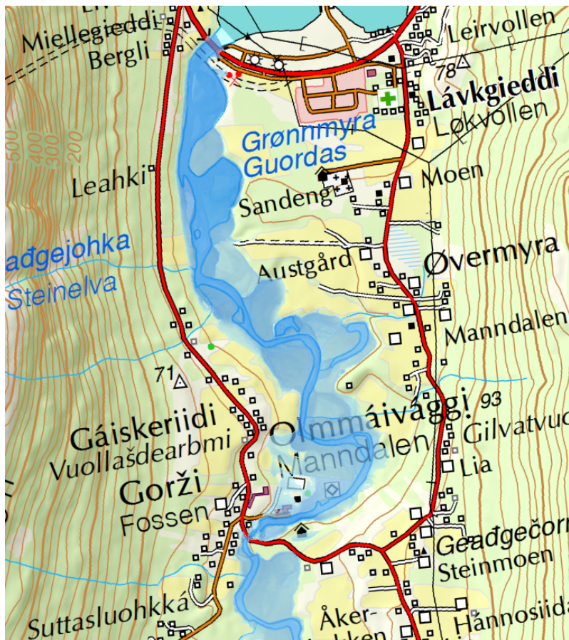
Figur 15 Kart over berørt areal fra dambrudd fra sjøen til Fossen. Blå farge viser oversvømt området der mørk blåfarge indikerer vandyp større enn 5 m.
