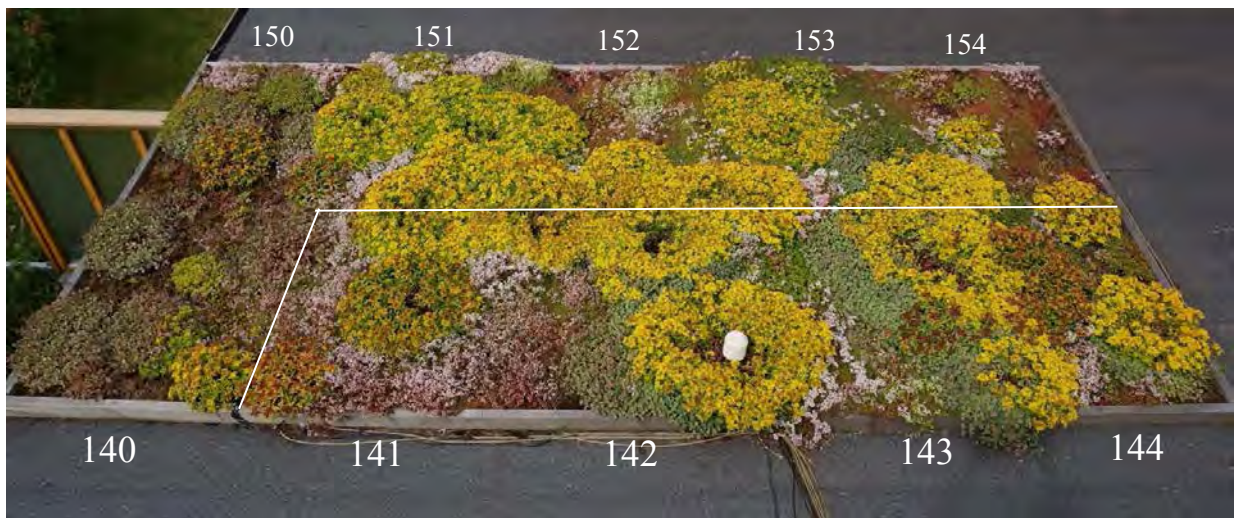
Figur 51. Tak 4, 7. juli 2014. Vannet område nærmest fotografen (141-144). Forskjellen mellom vannet og kun naturlig nedbør er minimal på dette flate taket. Rute 151 og 153 har filtmatte under sedummatta. Det er trolig en fordel når det ikke vannes.
