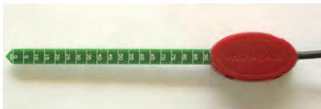
Fig. 10. Jordfuktighetsmåler fra Vegetronix med 10 cm sensor. Rimelig, men påvirkes av temperaturen (foto Vegetronix).
