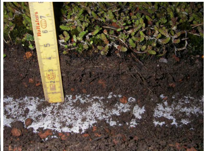
Fig. 46. En tynn dremsplate legges oppå takpappen før VegTech vekstmedium fordeles i ca 2 cm dybde. En plastlist legges mellom rute 144 og 154 og mot naborutene, før sedummattene legges tilbake. Rute 150 er laget på samme måte (ny type).
