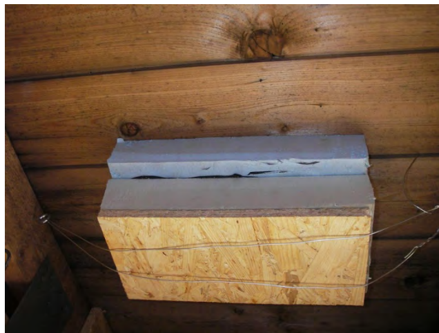
Fig. 9. Temperatursvingningene under tak med og uten vegetasjon av sensor omgitt av isolasjon.
