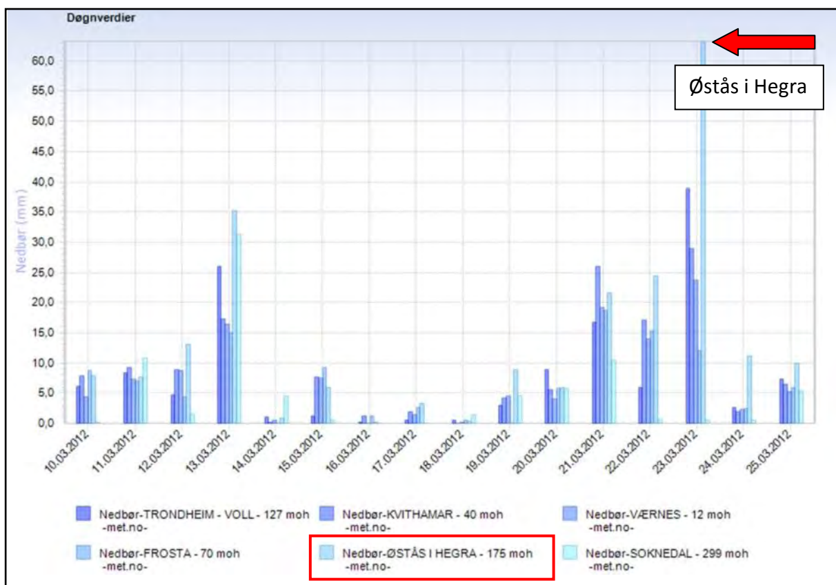
Fig. 11. Døgnverdier for nedbør for en del målestasjoner omkring SØ-lige del av Trondheimsfjorden for perioden 10. mars – 25. mars 2012. Østås i Hegra, Stjørdal kommune (røde markeringer), som ligger 175 moh. fikk klart mest nedbør 23. mars. Flest antall skred ble imidlertid registrert i Stjørdal kommune 22. mars. (SeNorge.no).
