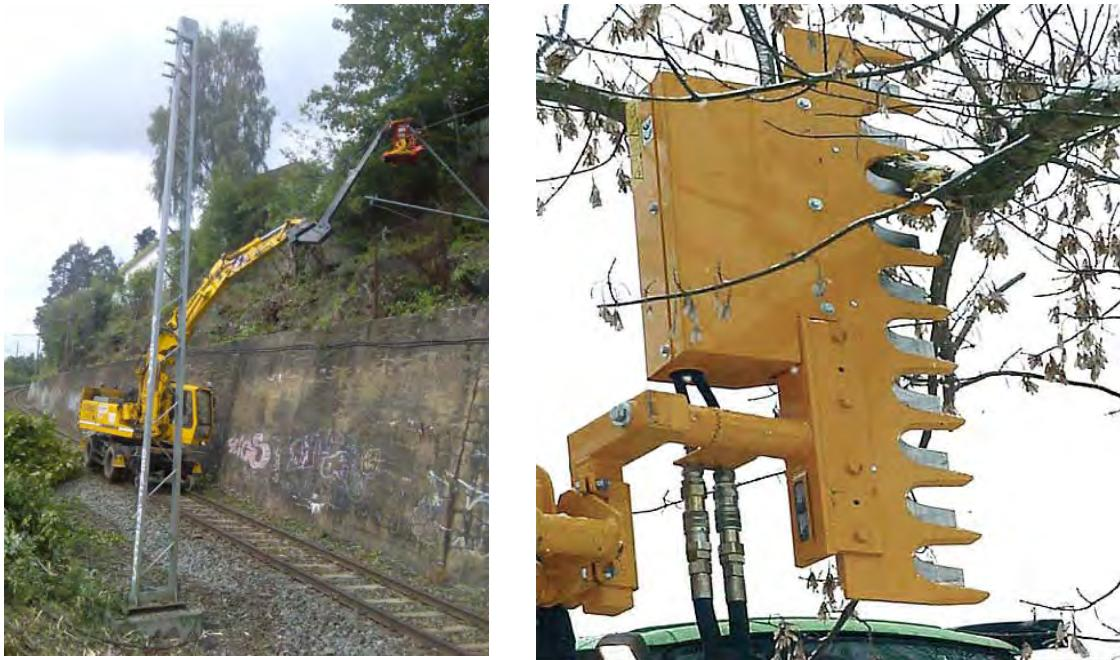
Figur 19 - Rydding av jernbanetrase (Baneteknikk AS)
