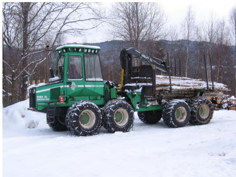
Figur 1 - Lassbærer for uttak av tømmer og GROT (L. Bugge)
