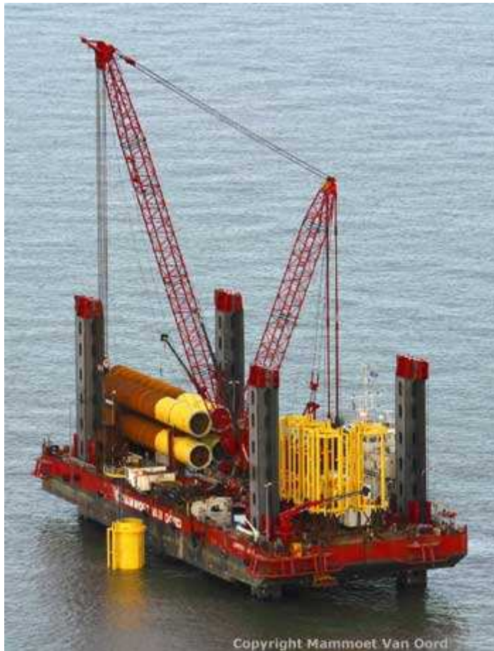
Figur 3-2 Spesialbygd fartøy for bygging av fundamenter til offshore vindkraft. Kilde: www.mammoetvanoord.com
