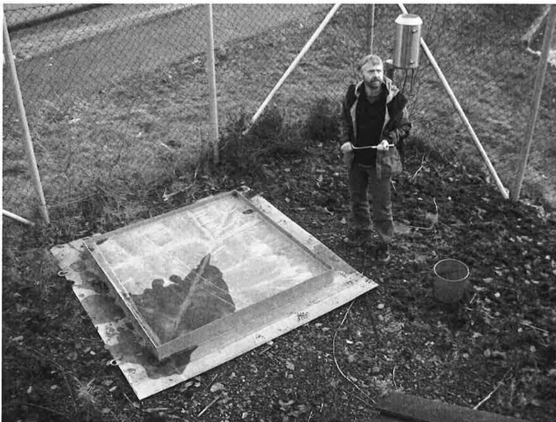
Figur 3. Urbanstasjonen Sandsli i Bergen med snøsmeltebrett og nedbørmåler (vippepluviograf). Snøsmeltebrettet gir informasjon om tidspunkt for smelting, samt avrenningsvolum (foto: B.C.Braskerud).
