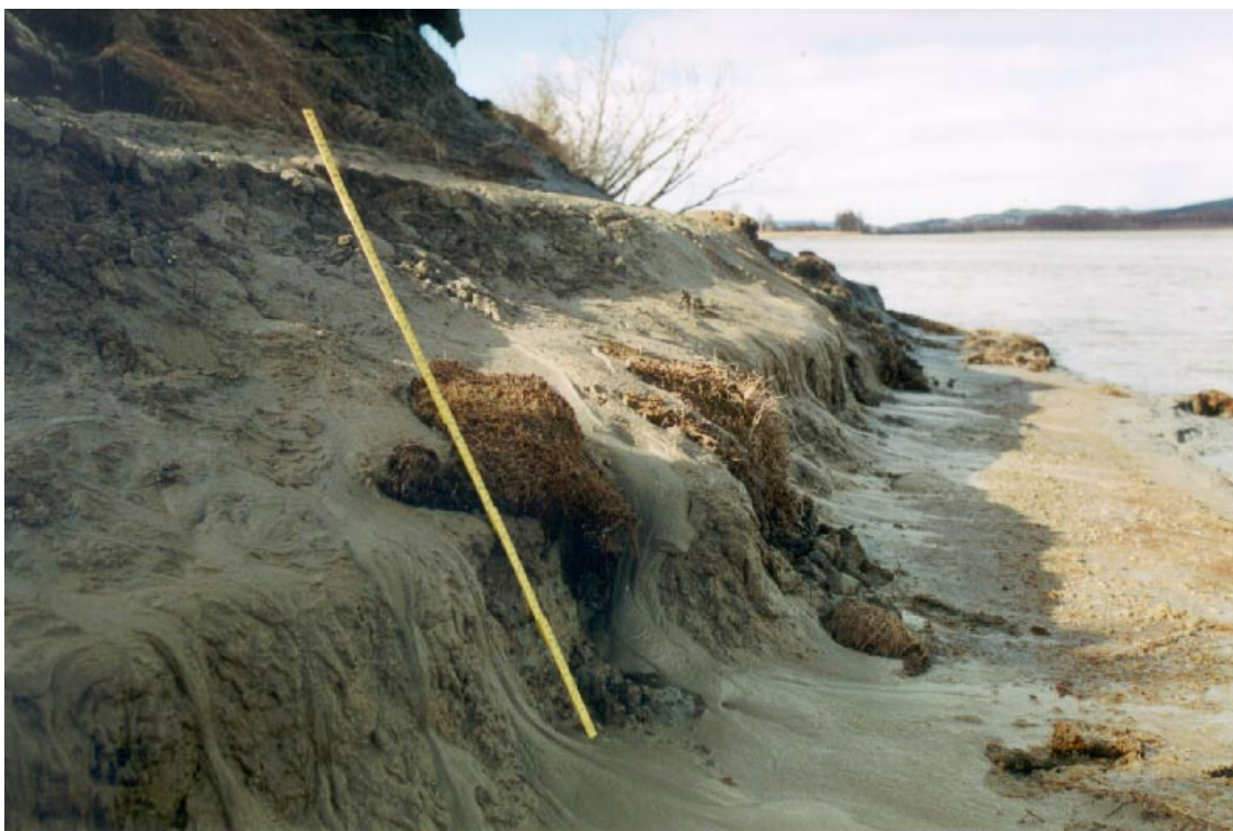
Fig. 5.3. Elveerosjon og frostprosesser ved Årnestangen. Oppbløtt materiale fra frostprosesser flyter ned elvebredden, vannstand kote 99.2. Foto 13. april 1995.
