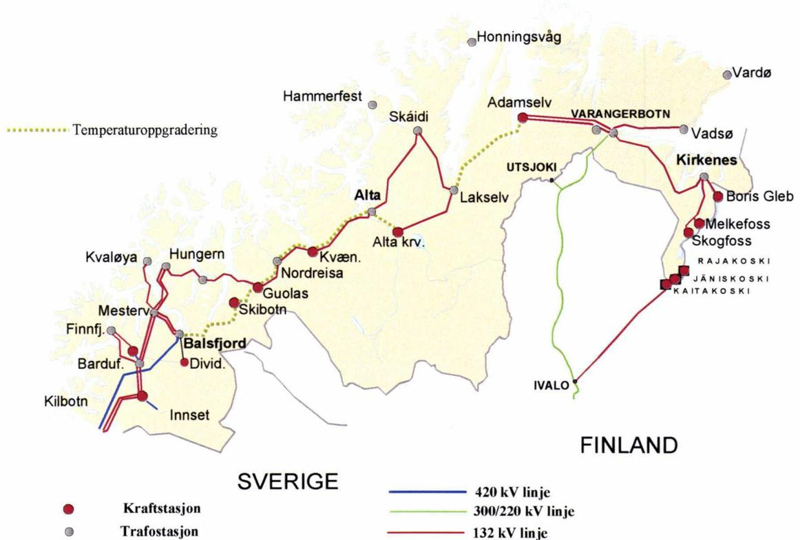
Figur 6.2: Nettet i nærområdene til de meldte vindparkene i Troms og Finnmark der temperaturoppgraderte ledninger er markert.
