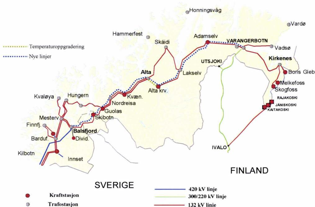
Figur 6.5: Nettet i nærområdene til de meldte vindparkene i Troms og Finnmark der temperaturoppgraderte ledninger og nye 420 kV ledninger er markert.
