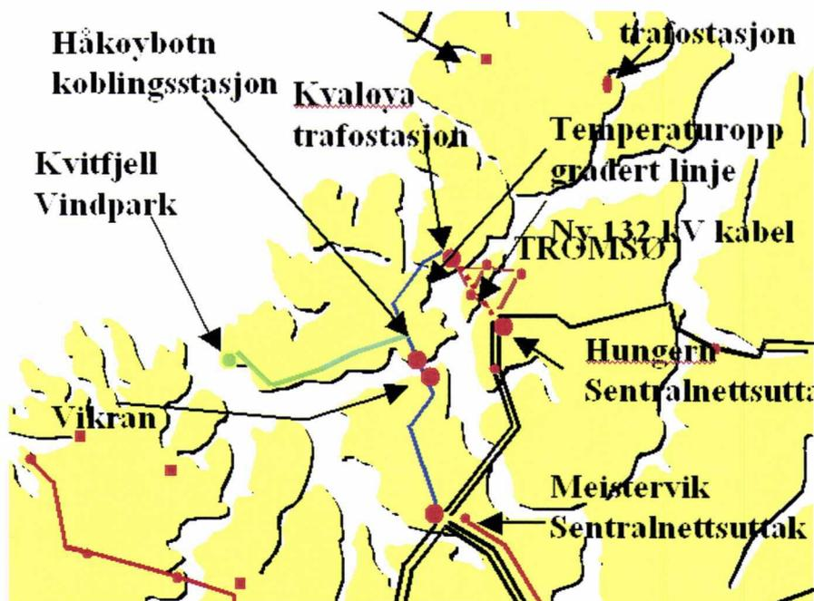
Figur 5.5: Temperaturoppgradert 132 kV-ledning mellom Larseng og Kvaløya, samt 132 kV kabel over Tromsøya.
