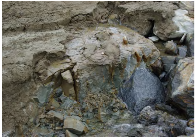
Fig 4.9 Innslag av leire i avsetningene i reguleringssonen. Avsetningene i Storvatnet består av silt og sand og stedvis finere materiale. Finfordelt materiale som eroderes i reguleringssonen tilføres som suspendert stoff til magasinet og kan føres videre ut i vassdraget.
