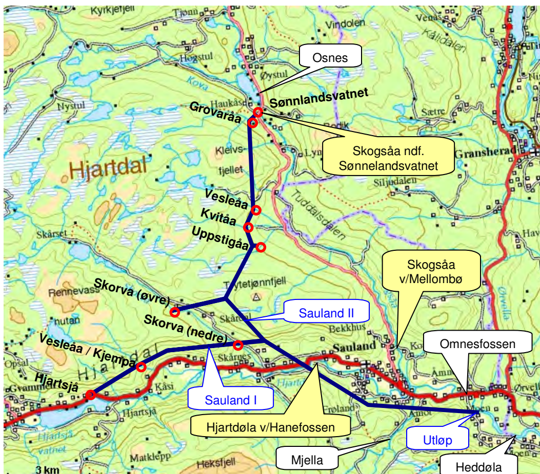
Fig. 2 Kartskisse over utbyggingen. Tunnelene er skissert med blått og inntakspunktene er markert med røde sirkler. Målestedene for vanntemperatur som er plottet i denne rapporten er markert med gul bakgrunn, og stasjonsnavnene er hentet fra NVEs database. Således er Sønnelandsvatnet det samme som Sønderlandsvatn, og Hanefossen det samme som Hanfoss.
