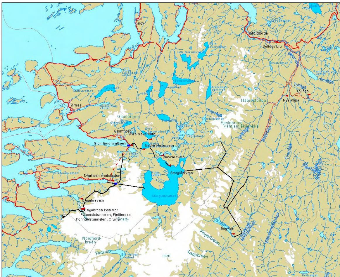
Fig. 1.1. Oversiktskart med avløpstasjoner, magasiner, og vannveier for kraftstasjoner.
