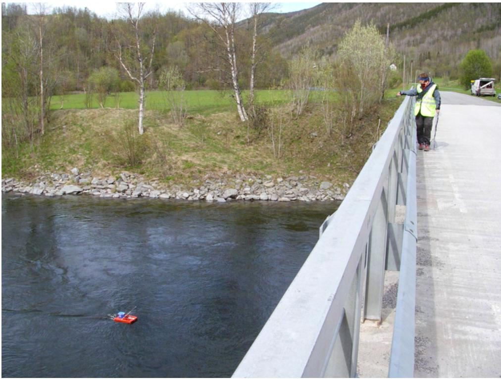
**Fig. 1.20. Vannføringsmåling fra Selfors bru med StreamPro**
