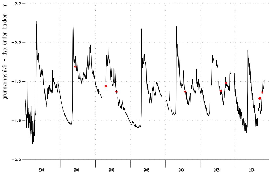
Figur 3. Observerte grunnvannsstand i rør-Kyrkjestølane i perioden 2000-2006 og kontrollmålinger (firkanter);
