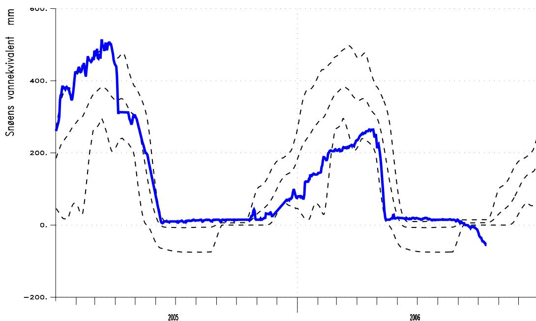
Figur 5. Snøens vannekvivalent målt i 2005-2006 sammenlignet med flereårsmiddel, største og minste observerte snøens vannekvivalent (stiplet) for perioden 1999-2005.
