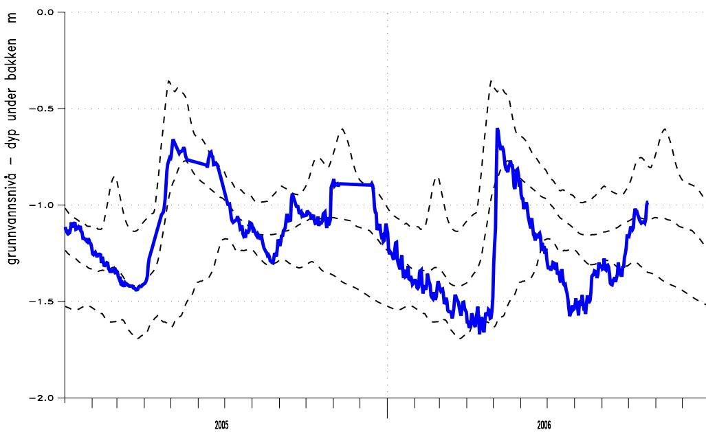
Figur 4. Grunnvannsnivå i 2005-2006 (uthevet) sammenlignet med flereårsmiddel største og minste observerte grunnvannsnivå (stiplet)<sup>9</sup>, for perioden 1997-2005 i rør Kyrkjestølane (interpolasjon på 100 dager). Manglende data: 12.11 til 12.12.2005.
