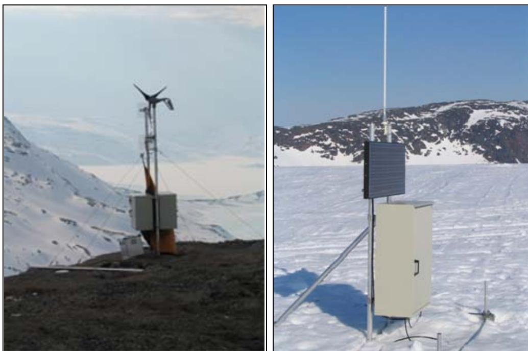
Figur 10. Bilde til venstre viser Fjellstasjon med radio- og telefonsamband, logger, geofon i fjell og sensor for lufttemperatur og lufttrykk. Til høyre vises brestasjon utplassert på isen med radiosamband, geofoner og logger. Foto Rune V. Engeset.
