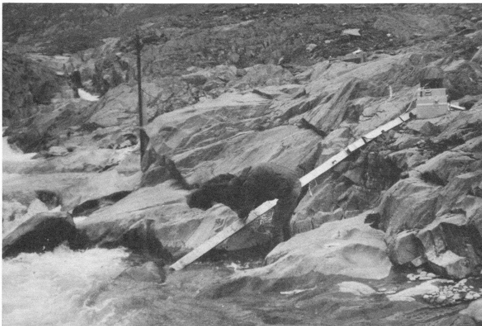
Fig. 3. ISCO vannprøvetaker i Vegdalen. Trykklimnigraf og vannmerkeskala i bakgrunnen.
