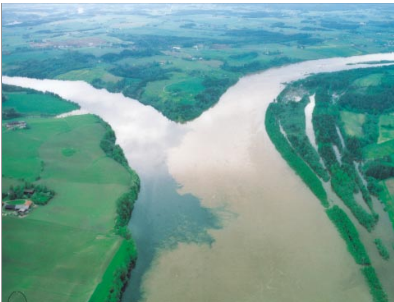
Figur 1.2 Samløpet mellom Vorma og Glomma under flommen i 1995. Vorma har liten massetransport sammenliknet med Glomma. Grunnen til dette er at Vorma har utløp fra Mjøsa, som fungerer som et sedimentasjonsbasseng. (Foto: FOTONOR AS)
