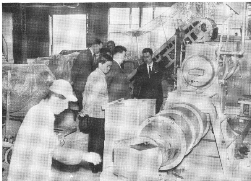
Massen går gjennom vakuumpresse for å fjerne eventuelt luftinnhold.
