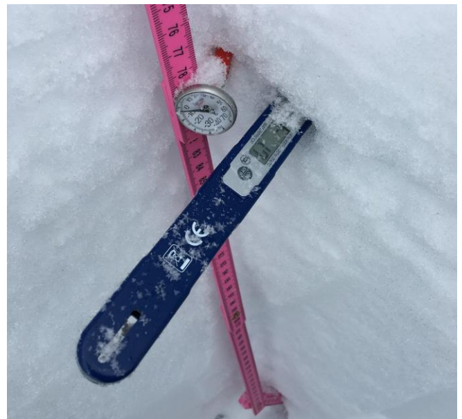
Figur 3: Et eksempel der temperaturen i snødekket måles med et analogt og digitalt termometer. Sistnevnte er mest nøyaktig (Foto: Njål@SVV/Regobs).
