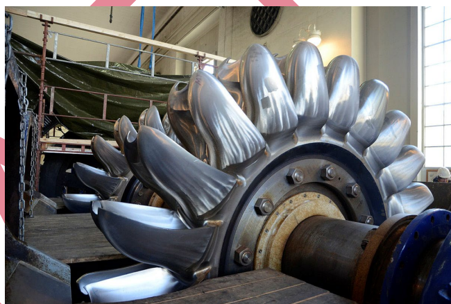
Figur 5: Peltonløpehjul under revisjon i Nore I Foto: Thomas Mo Willig / NVE
