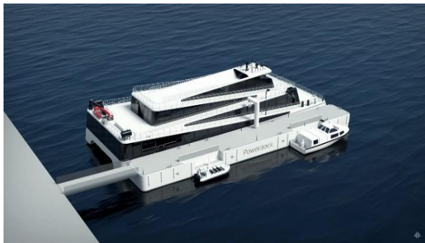
Figur 2: Powerdock, en flytebrygge med et 2,4 MWh batteri. Illustrasjon: Brødrene Aa
