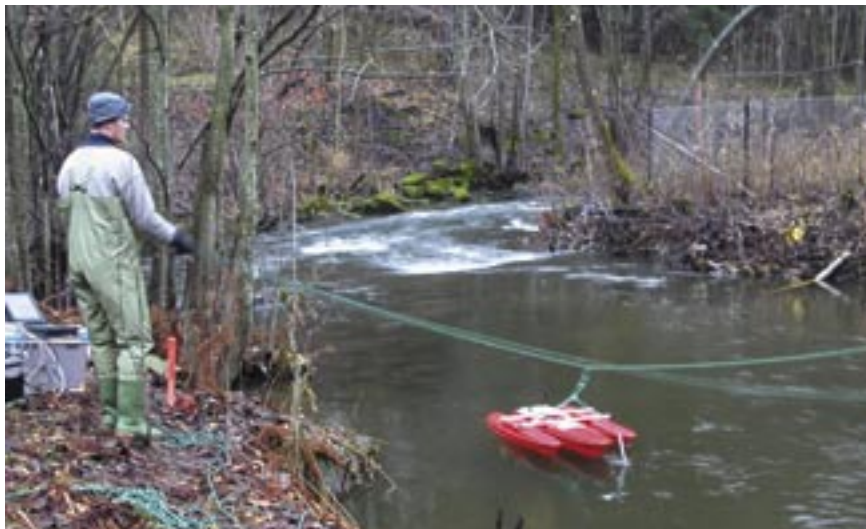
Hydroakustisk måling med ADCP
