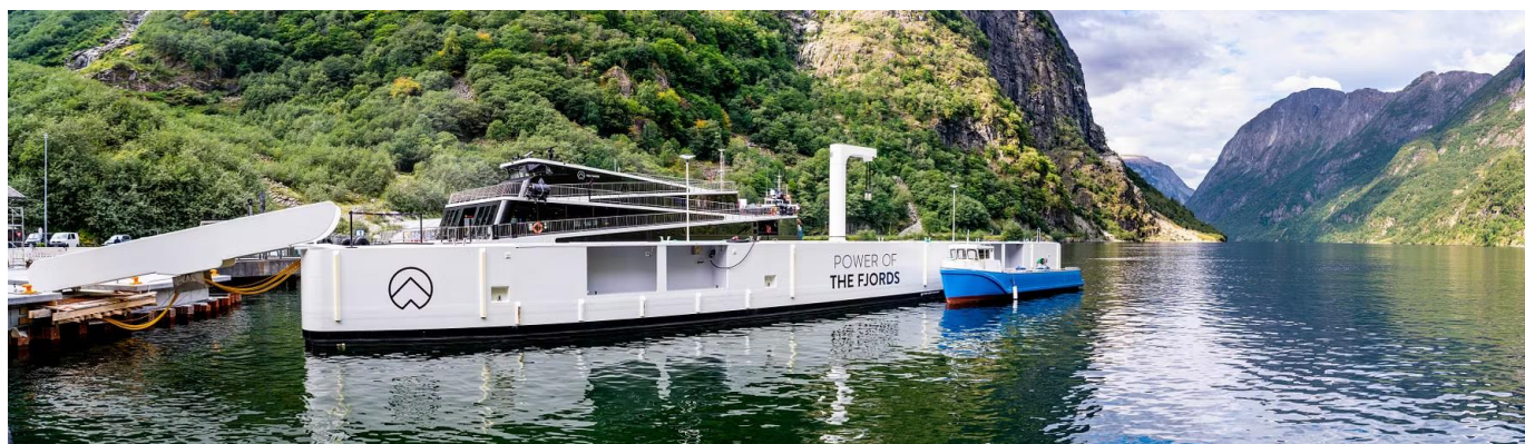
Bilde 1. Den flytende batteripakken muliggjør hurtiglading av ferger «Future of The Fjords». Foto: norwaysbest.com / Sverre Hjørnevik
