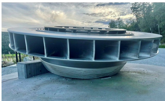
Figur 5: Utskiftet Francisløpehjul fra Kvilddal kraftverk.
