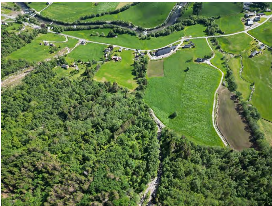
Foto 29 Sikringstiltaket der skredbane 5 kommer ned mot jordet har en overhøyde i forhold til bekken på ca. 2 m. Tiltaket vil i hovedsak sikre for vann, men hvis masse legger seg bak vollen, vil en få overtopping. Søkket før Langevegen til høyre i foto er ikke et sikringstiltak, men en ev vegfylling som tidligere har gått til brudd.
