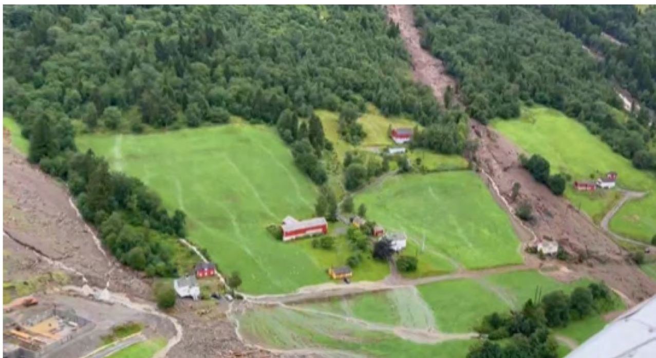
Figur 2-5 Dronefoto fra rapport for dokumentasjon av skade, Arnt Jørgen Sønslie (Sønslie, Rasskade etter 30. juli for Gbr 314/11-12 og Langedalsvegen, 2023). Vann konsentreres i grunne søkk.
