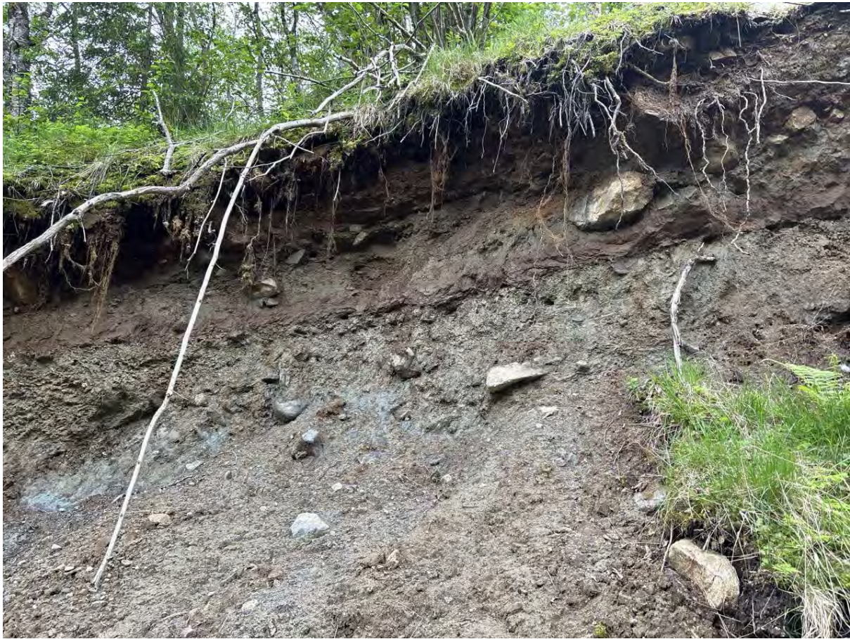
Figur 2-12 Løs masse tykkelse ca 3 m deretter trolig berg. Over den oksiderte flata tolkes massene som skredavsatt, under denne flata er et sandlag som er deformert. Sanda er stedvis tilnærmet som støpesand, andre steder er den grovere. Underliggende leirige masser tolkes som et morenelag. Sandlaget kan knyttes til strandlinja som ligger i Figur 2-11. Infopunkt 48 - Se vedlegg C2 for plassering.
