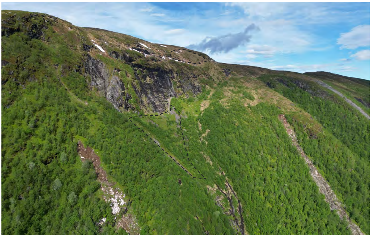
Figur 5-2 Løsneområder for jordskred nr 1(til høyre) og 2(venstre) på hver side av Vedafonnbotnen. Skogen i selve botnen er snøskredskadet og ligger mye nede. Som løsneområder for snøskred er løsneområde 10 inne i
