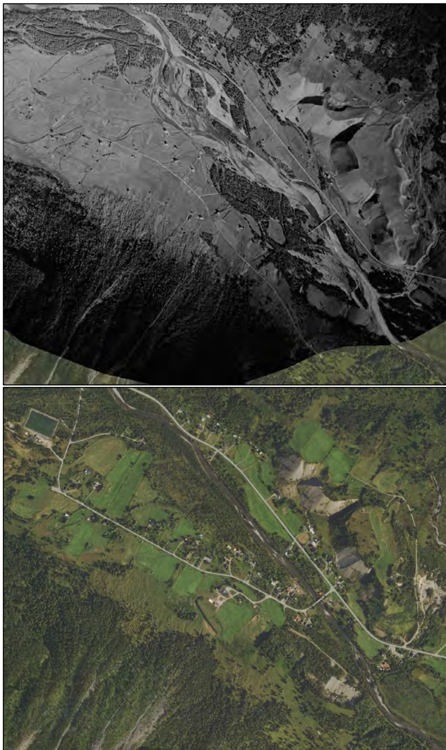
Figur 6-8 Øverst: flybilde fra 1947. Nederst: flybilde fra 2024. Vegetasjonen og bebyggelsen i området er fortettet. Nye blokkutfall fra fjellsiden sør for kartleggingsområdet er synlig ved sammenligning av flybildene. Kåfjordelva har blitt betydelig utbygd senere år, og det aktive fluviale området er redusert.
