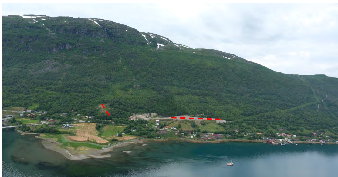
Figur 4-10 Ledevoll (t.v./sør) og fangvoll (t.h./nord) er markert med rød stippet linje.
