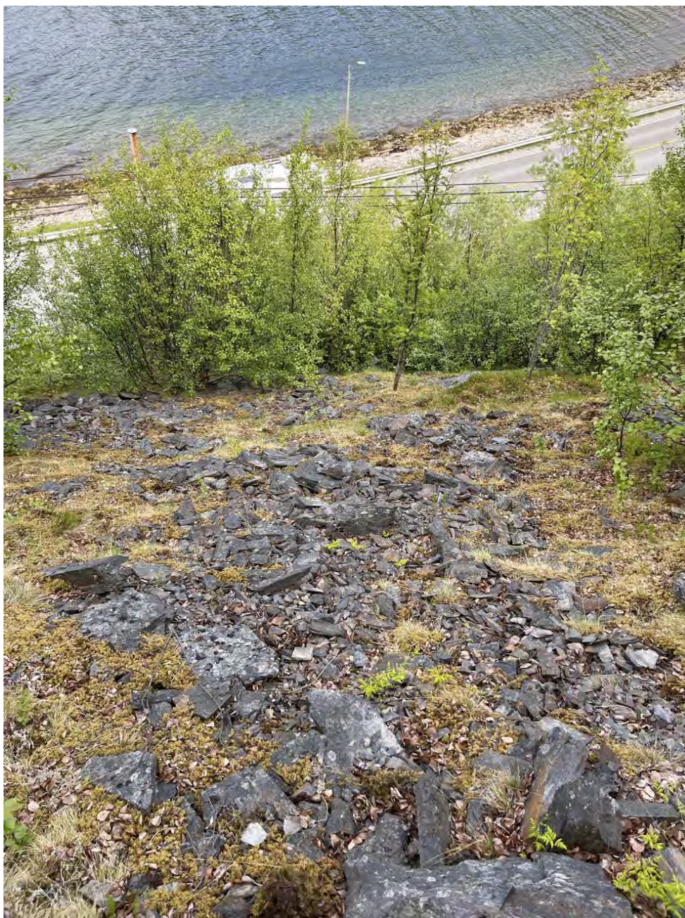
Foto 9.21. Potensiell remobilisering av blokker sørvest i kartleggingsområdet.
