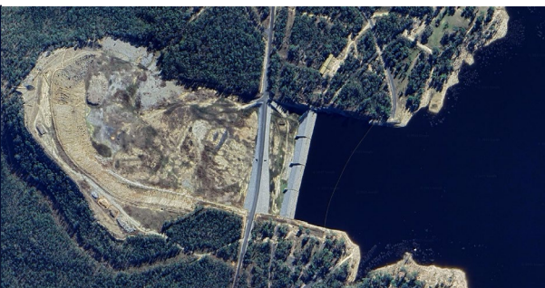
Figur B 21 Copeton Dam og et 250 m langt eroderbart flomløp med sikringsdammer, fullført 2013. (Figurer fra Google Earth).
