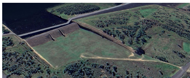
Figur B 19 Wivenhoe Dam og et 165 m langt eroderbart flomløp med tre sikringsdammer, bygget 2005. (Figurer fra Google Earth).
