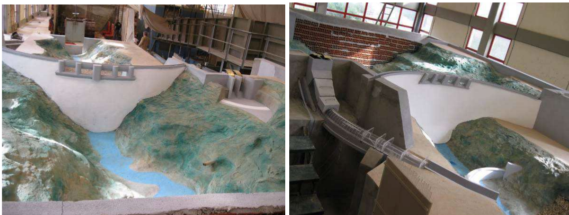
Figur B 12 Salamonde dammen. Modell av dammen og hjelpeflomløpet, fra oppstrøms side i bildet til venstre og nedstrøms side. I bildet til høyre. Figur fra Muralha, Couto, Oliveira, et al. (2015)
