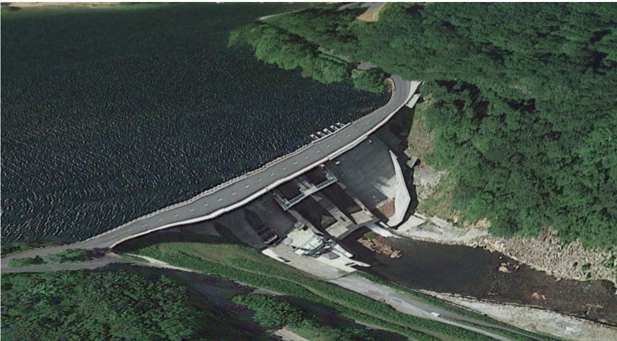
Figur 48: La Raviege dam, Frankrike, bilde fra Google Earth. Hvor hovedflomløpet er lokalisert midt på dammen og nytt flomløp med PKW er lokalisert til venstre for hovedflomløpet, sett i medstrøms retning
