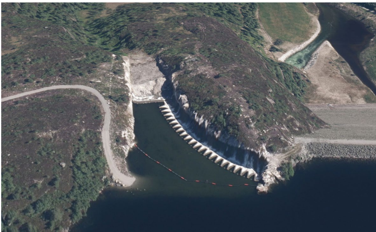
Figur 5: Flyfoto i 3D av labyrintflomløp ved Dam Deg ( www.norgeibilder.no )
