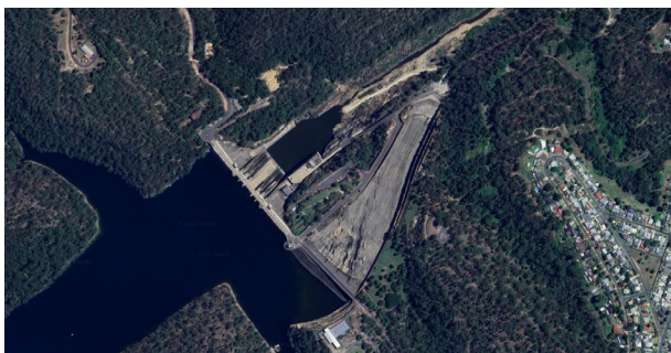
Figur B 20 Warragamba dammen og eroderbart flomløp med sikringsdammer. (Figurer fra Google Earth).
