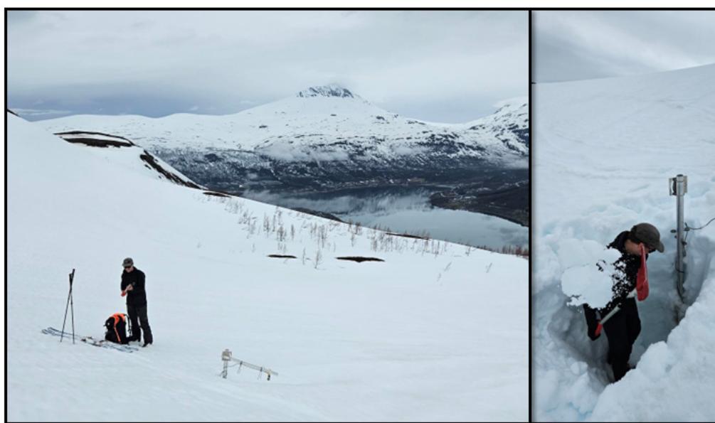
Figur 5-4 Eksempel på en nedsnødd snøsensor fra Lavangsdalen i vinteren 2024/2025. Plassering av sensoren ble valgt uten tidligere kunnskap om snøfordeling eller systematisk bruk av klimadata og lokalkunnskap.
