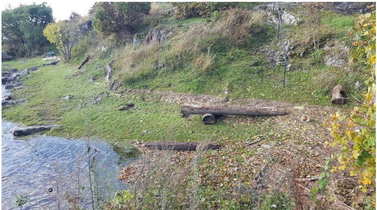
Figur 5-28. Viser tydelige spor i terrenget etter ved kalibreringspunkt 9 ved Hølen, og gir et eksempel på en relativt sikker vannstand ved flomtoppen. Foto: NVE.
