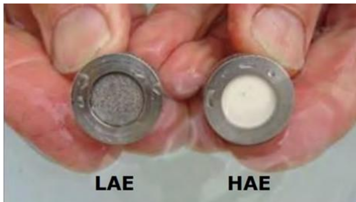
Figur 3-11 LAE og HAE filter for membran baserte piezometre (bilde: Geosense).
