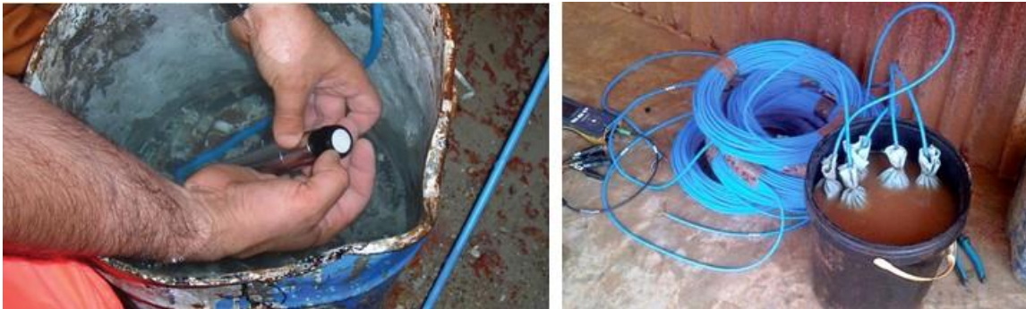
Figur 3-12 Metting av piezometre før installasjon (bilder: Sisgeo).
