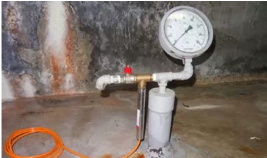
Figur 3-9 Eksempel på lukket hydraulisk piezometer med manometer og trykk giver. Bilde: Geosense. Ved artesisk trykk bør det monteres lukkeventil på koblingen til standrøret slik at trykk giveren enkelt kan skiftes ut.
