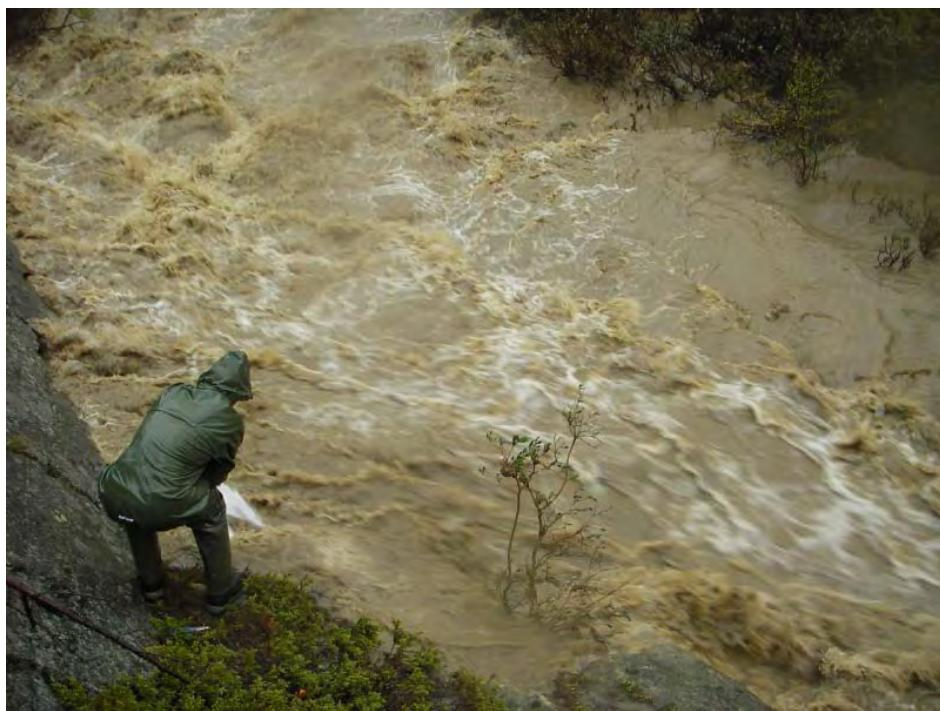
**Figur 24. Utslepp av salt til vassføringsmåling i Folla. Målestasjon 2.592 Fokstua, 10.juni 2011. Foto: Bjørg Lirhus, NVE.**
