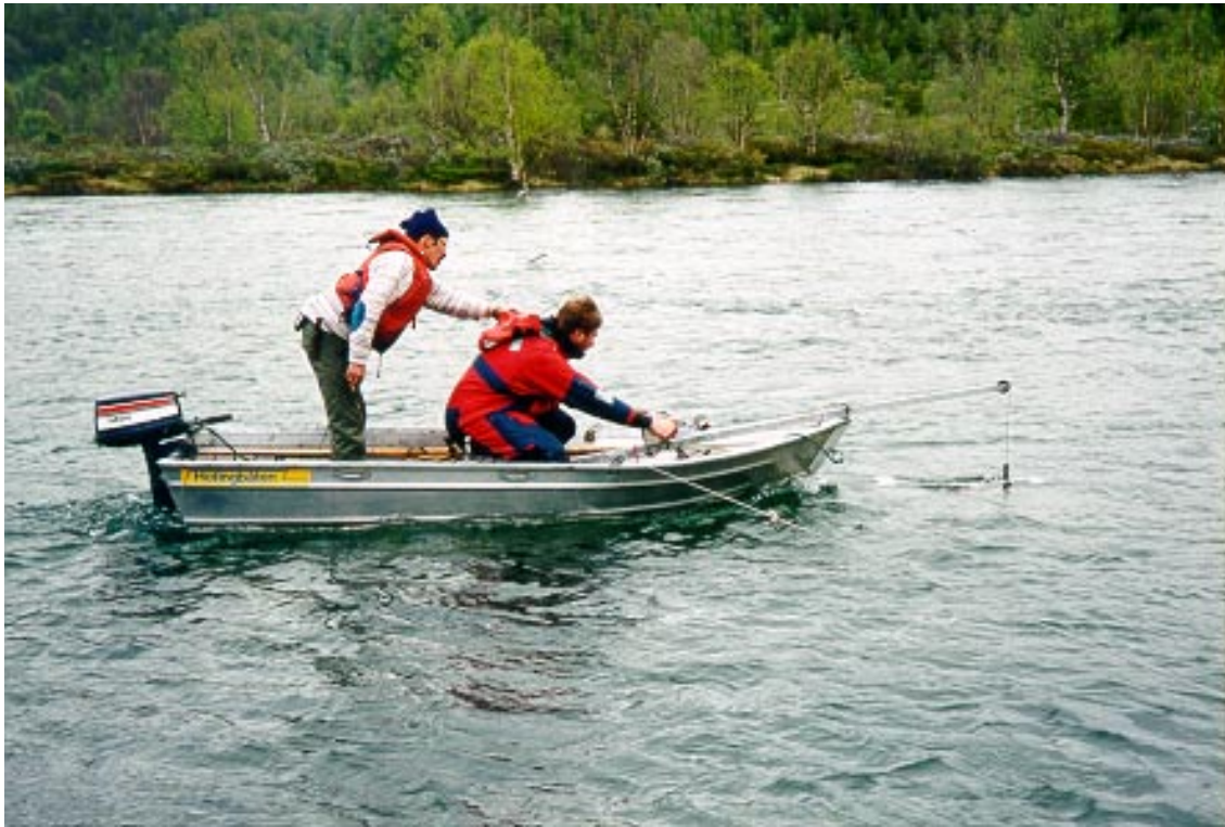
Fig. 3.3.1. Vannføringsmåling fra båt med opphengt flygel. Selv under rolige strømforhold skal sikkerhetsdrakt eller flytevest benyttes. NB: Personen som har reist seg gjør båten fremtung.
