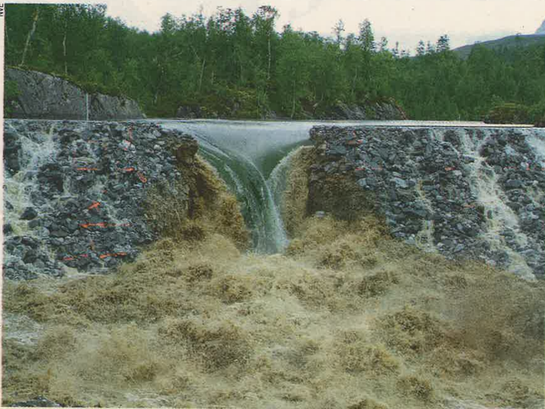
Bildet viser en 6 meter høy dam, eller demning, som ble bygget i Røssåga i Nordland i anledning et dambruddsforsøk høsten 2003. Dambruddet var en del av forskningsprosjektet "Stabilitet og bruddforløp av dammer". Informasjonen fra prosjektet er viktig for NVE og bransjen med tanke på å bedre forståelsen av hvordan brudd utvikler seg i steinfyllingsdammer.
