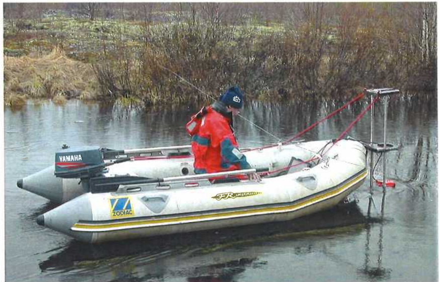
Måling av vassføring ved bruk av Acoustic Doppler Current Profiler (ADCP). Foto: Kai Fjelstad
