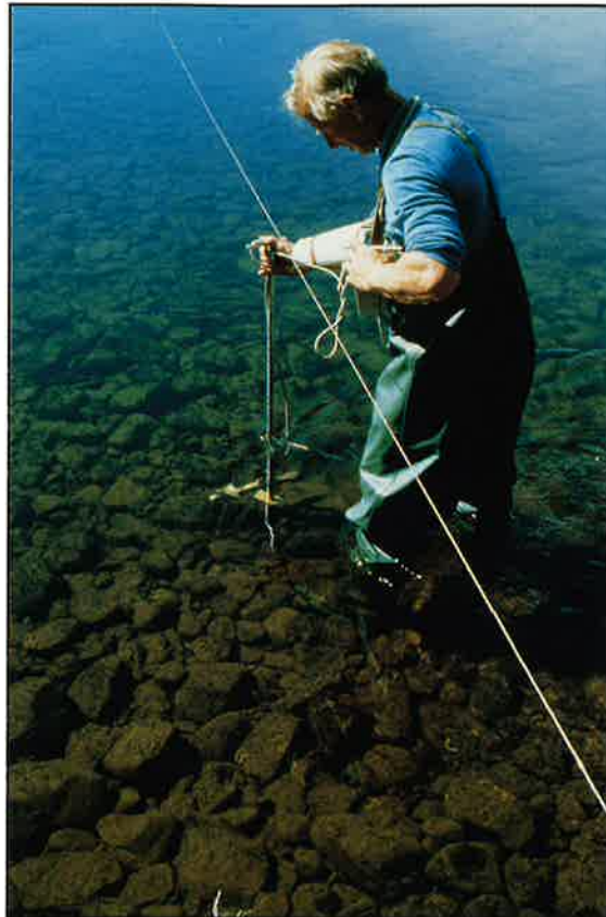
Vannføringsmåling. Vannets hastighet måles med flygel i flere punkt i elveprofilen.
