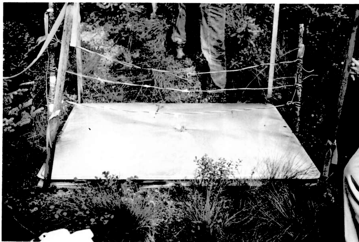
Figur 7. Snøpute laget av rustfritt stål.
