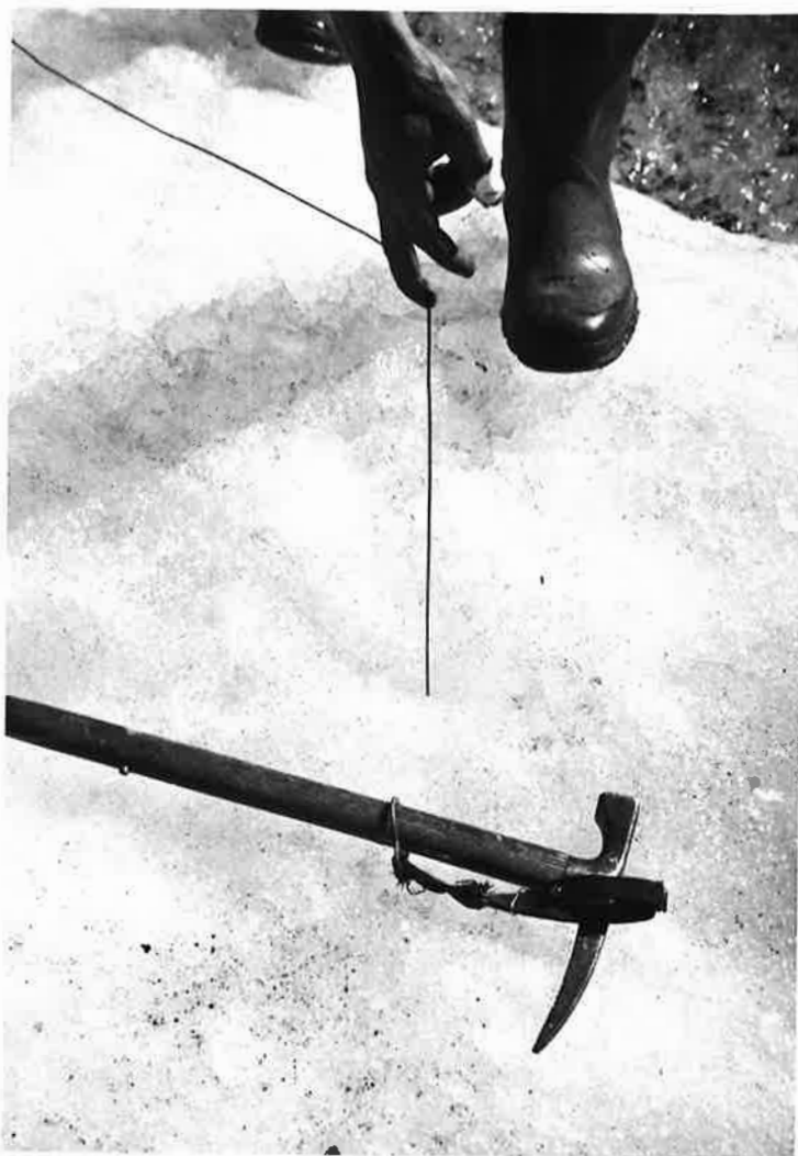
Fig.nr. 22 På breer med vanskelig adkomst eller der en særskilt stor avsmeltning forekommer, har man på forsøk gått over til å bruke en nedboret stålwire istedenfor aluminiumstaker for å måle ablasjonen. Wiren festes til en tetraederformet konstruksjon og kan derfor lett finnes igjen. Ablasjonen finnes ved å måle den del av wiren som har smeltet fram siden foregående måling. Wiren viser breoverflatens senkning med stor presisjon hvis den er plassert vertikalt ved innfrysningen i isen.
