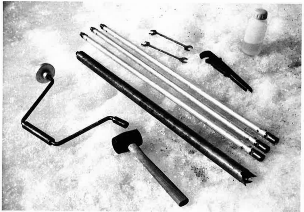
Fig. nr. 32 . . . . . Fra arbeidet med nedboring av staker på Storsteinfjellbreen. Boret som består av et stålrør med grove tenner (se nederst) må ofte heises opp og tømmes. Ved spesielle temperaturforhold kan dette være en meget tidskrevende og arbeidsom del av boringen. Hvis boret fryser fast i hullet, må man enten hugge det løs- noe som kan ta flere dager hvis hullet er dypt - eller man kan forsøke å helle ned rödsprit, som i de fleste tilfeller vil kunne løse opp isen rundt boret.
