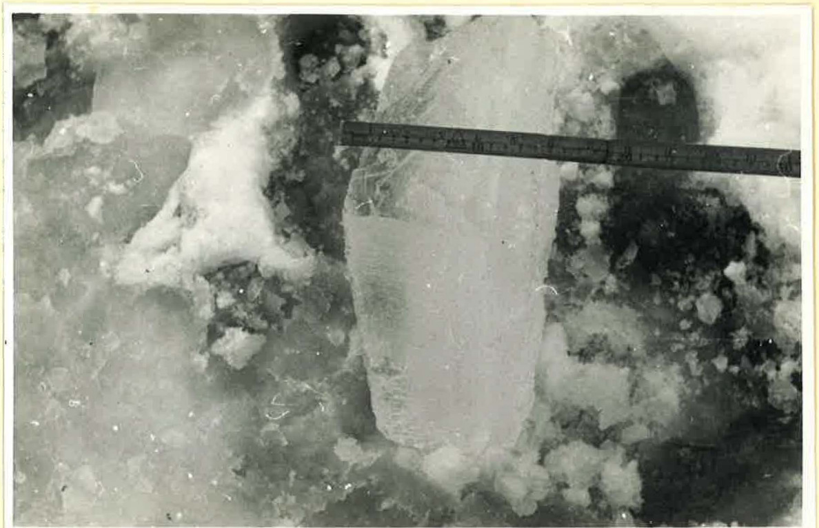
Måling av isens bruddfasthet 24/11 1952
