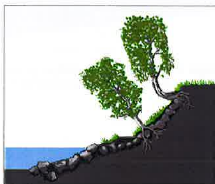
Figur 9: Trær på erosjonssikring. Rot-system på erosjonssikringen kan binde stein, men ved rotvelt vil noe stein følge med. Ved neste flom kan dette bli et nytt angrepspunkt for erosjon.
