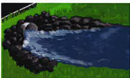
Figur 10: Innløp til kulvert. Stort press ved kulvert med for liten kapasitet. Dette sliter på erosjonssikringen rundt røret.
